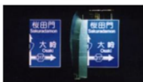
左:広角プリズムのキューブ型 右:再帰型カプセルレンズ型 120m観測より
